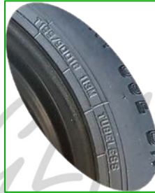
Ilustración 4. Zoom del código del neumático, en este caso «T155/90D18 113M»
