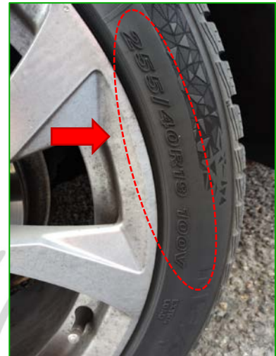
Ilustración 7. Detalle código del neumático, 255/40R19 100V
