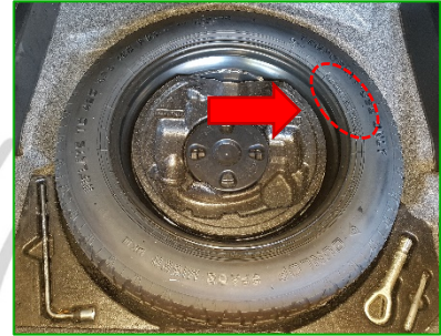
Ilustración 5. Código del neumático de la rueda de repuesto
