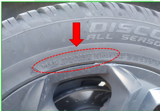
Ilustración 6. Detalle código del neumático, M+S 235/55R17 103V
